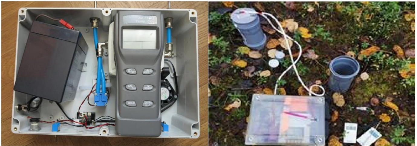
Рисунок 5. Анализатор \text{CO}_2 закрытого типа, созданный на основе промышленного инфракрасного газоанализатора тайваньского производителя AZ Instrument (Карелин и др., 2015)
