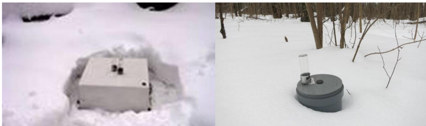
Рисунок 4. Два типа измерительных камер для определения эмиссии \text{CO}_2 из почвы в зимний период (Московская область). Фото И.Н. Кургановой, Д.В. Сапронова (ИФХиБПП РАН).
