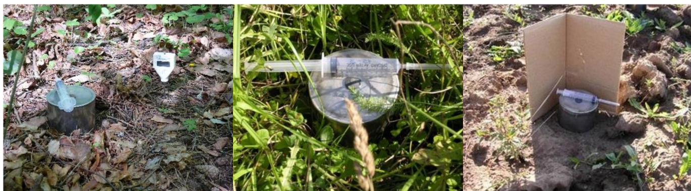
Рисунок 3. Установка измерительных камер в лесном, луговом и агроценозах (Московская область). Фото И.Н. Кургановой, В.О. Лопес де Гереню (ИФХиБПП РАН).
